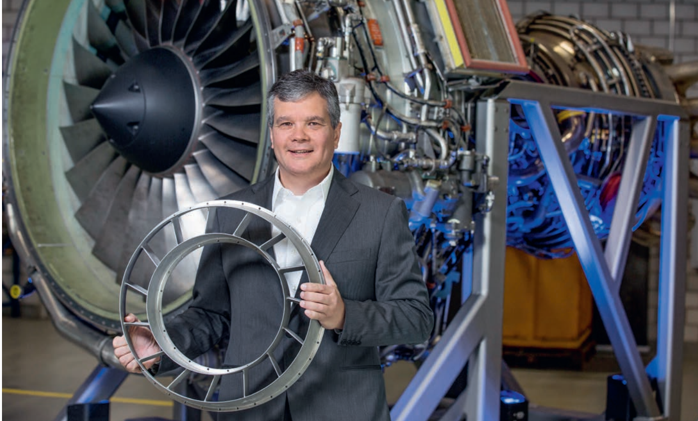
Carlos Vasto, Präsident GF Casting Solutions, präsentierte am Capital Market Day von GF einen Turbinenleitschaufelring für eine Flugzeugturbine – eine der grössten Komponenten auf dem Markt, die mit additivem Verfahren hergestellt werden.
